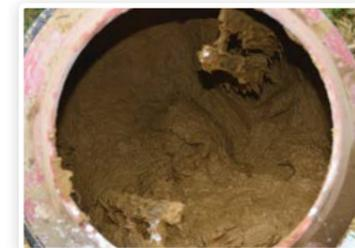
Gobetis : couche d'enduit très liquide, permettant aux couches suivantes d'enduit de s'accrocher
