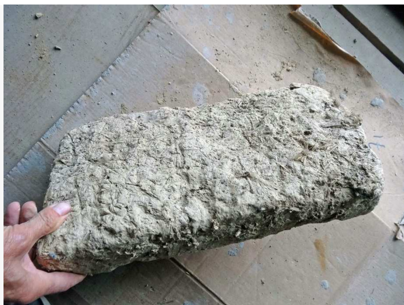
Figure 5 : Une adobe de terre crue et de fibres végétales
