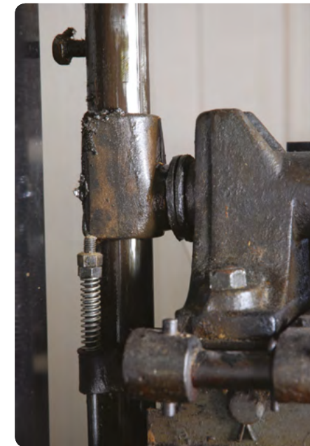
Le parachute : mis au point dès 1853 par Otis, ce système de sécurité empêche la chute de la cabine en cas de rupture de câble.
