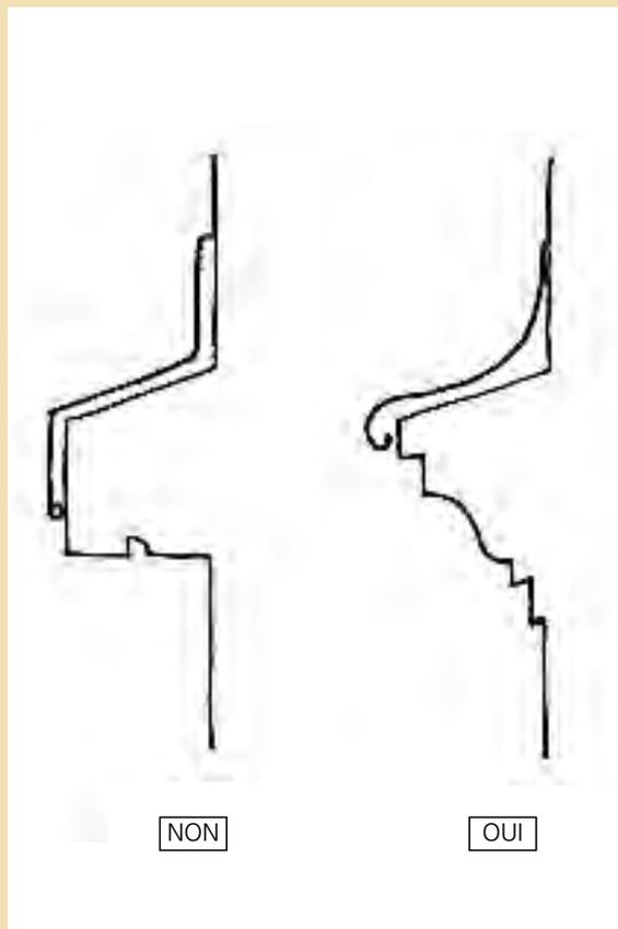
Les moulures horizontales doivent permettre d'éloigner les eaux de ruissellement au niveau des "gouttes d'eau" tout en apportant un élément décoratif à la façade, accentuant les jeux d'ombre et de lumière.
