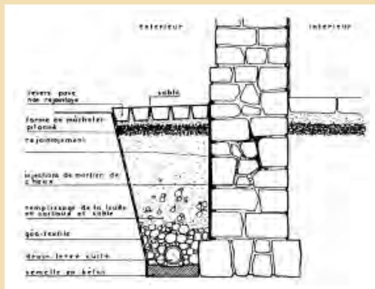
Puis, la fouille est comblée de cailloux, de gravillons et de sable propre, après qu'elle ait été préalablement tapissée d'un géotextile empêchant la terre d'infiltrer et de colmater l'ensemble du drainage.
