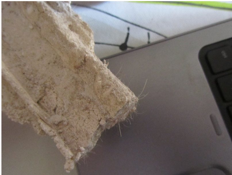
Figure 11 : Plâtre avec poils d'animaux (source : CREBA)
