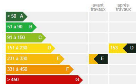
Figure 37: Consommation calculée avant et après rénovation
