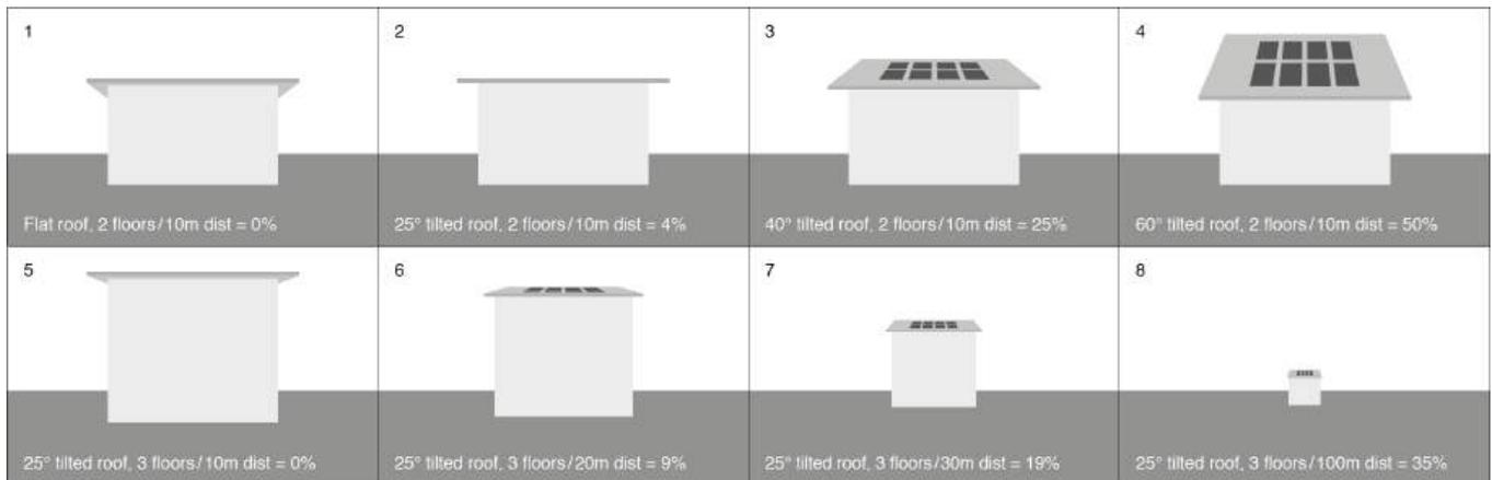
Figure 29 : Simulation de l'impact visuel des distances d'observation pour un bâtiment de 3 étages avec un toit en pente (Crédits EPFL/LESO-PB)
