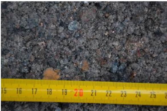
*Échantillon de béton de mâchefer prélevé sur un chantier de démolition, 80 rue Philippe De Lassalle à Lyon 4, 2019, © J. Sordoillet, CAUE Rhône Métropole*
