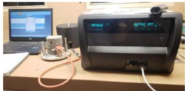
Dispositif expérimental complet utilisé dans la mesure de la conductivité et de la diffusivité thermique
