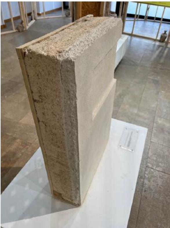
Échantillon de béton de chanvre, exposition TerraFibra Architectures (co-production Pavillon de l'Arsenal, amàco, Grands Ateliers) présentée au CAUE Rhône Métropole (2023)
