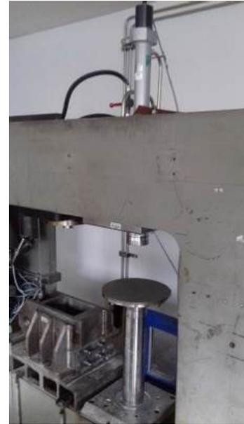
*Presse utilisée pour les écrasements lors des essais mécaniques en laboratoire, © Cerema*
