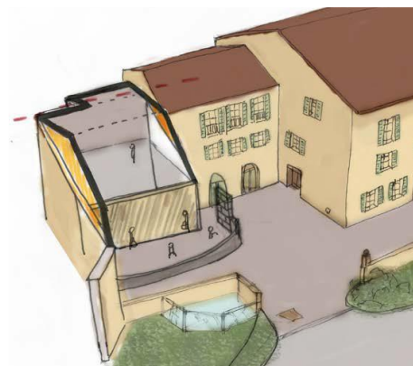
Figure 34 : Surélévation de la maçonnerie
