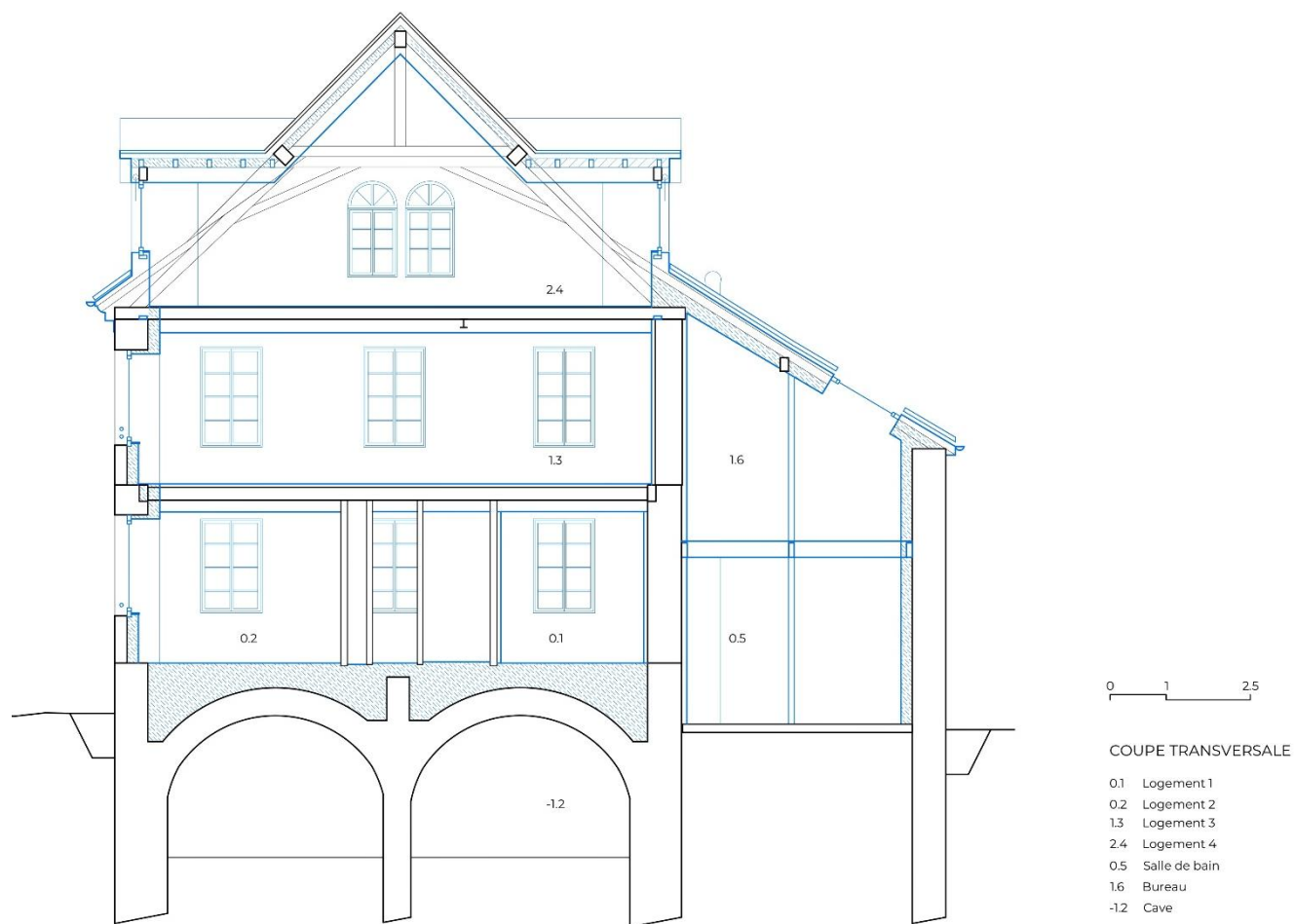
Figure 41 : Coupe transversale projet (source Mayker Architectes)
